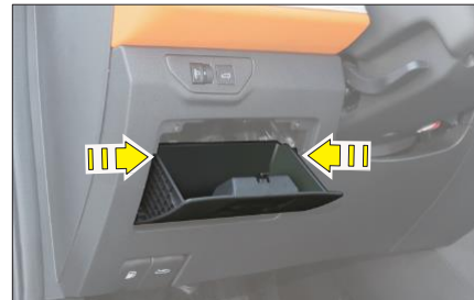
Блок предохранителей в салоне
