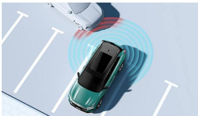
Система предупреждение об опасности столкновения сзади (RCTA)
